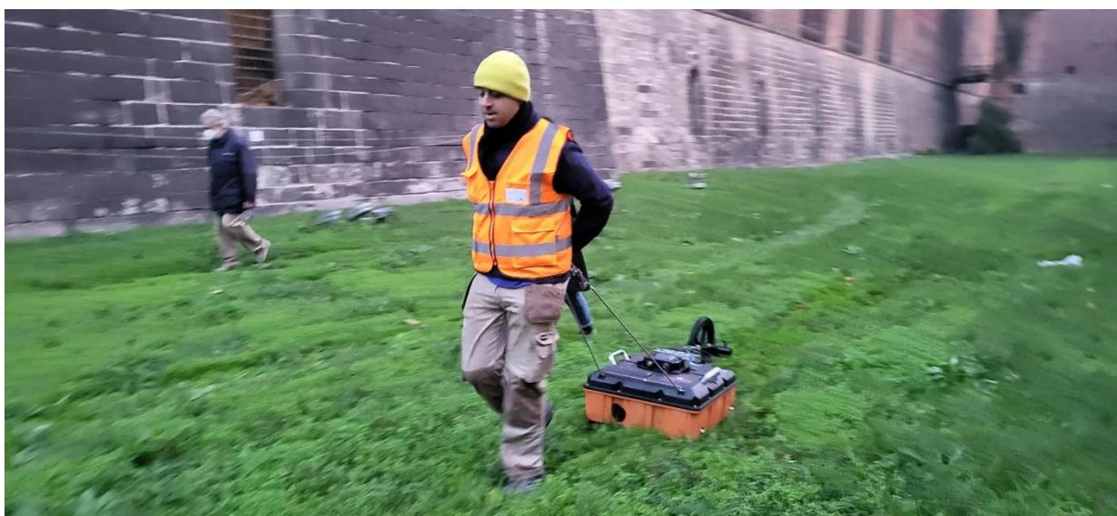
**Figura 5. Rilievo georadar nel fossato con il sistema GSSI 200 MHz HS**
