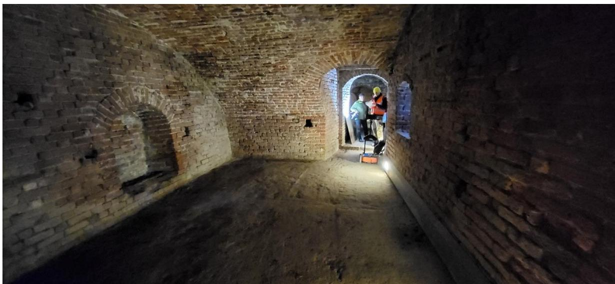
**Figura 4. Rilievo georadar nella galleria di controscarpa con il sistema GSSI UtilityScan 350 MHz HS**
