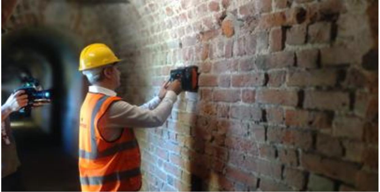
**Figura 6. Rilievo georadar nella galleria di controscarpa con il sistema GSSI Flex NX**
